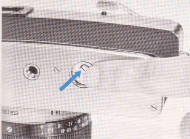
\* Wenn der Film zu Ende kommt, und der Aufzughebel 15 sich während der Betätigung nicht weiter bewegen lässt, wenden Sie nicht Gewalt an. Den Rückspulknopf 23 drücken und den Aufzughebel 15 bei zum Ende bewegen, indem man den Knopf in gedrückter Stellung hält. Der Aufzughebel springt dann in Anfangsstellung zurück.
